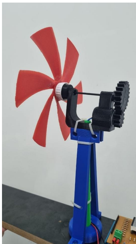
Figura 1 – Encaixe da hélice.
