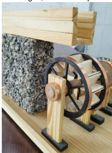
Figura 11: Representação da estrutura de entrada de água, a roda e as pás
