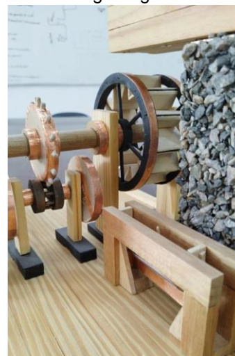
Figura 12: Representação do eixo e conjunto de engrenagens
