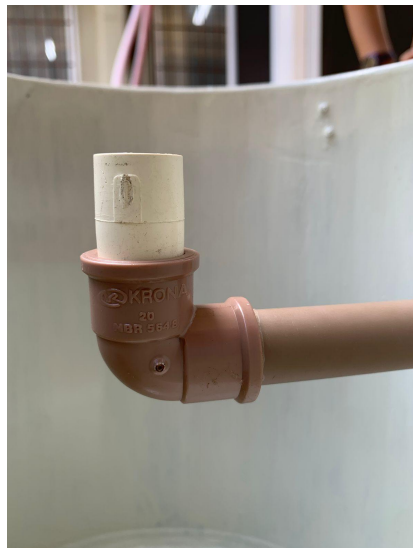
Figura 8 - Saída d'água com da luva para adaptação no dispositivo Jominy.
