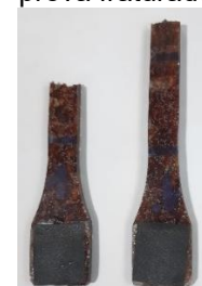
Figura 4 - Corpo de prova fraturado
