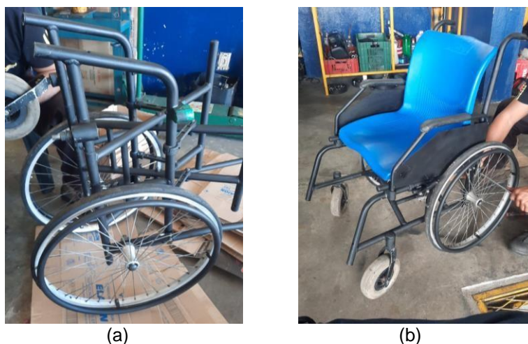
Figura 3 – Nova cadeira de rodas após o lixamento, pintura e fixação do assento plástico.
