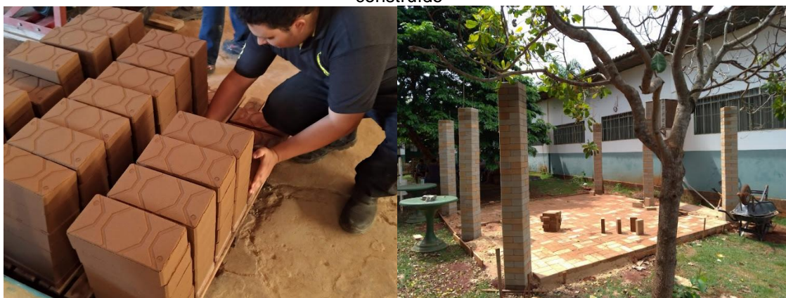
Figura 3: Tijolos solo-cimento prensados na empresa e o piso construído
