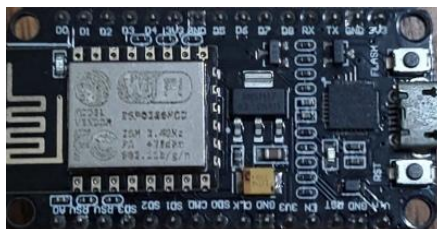
Figura 3 – Controlador e Processador integrados a Placa NODEMCU Esp8266 v2.
