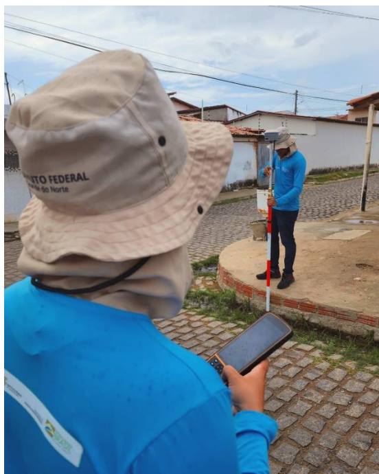
Figura 2 – Uso de equipamento tipo RTK em levantamento fundiário.
