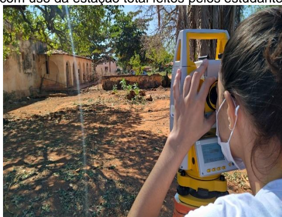
Figura 9 – Realização de levantamento topográfico com uso da estação total feitos pelos estudantes
