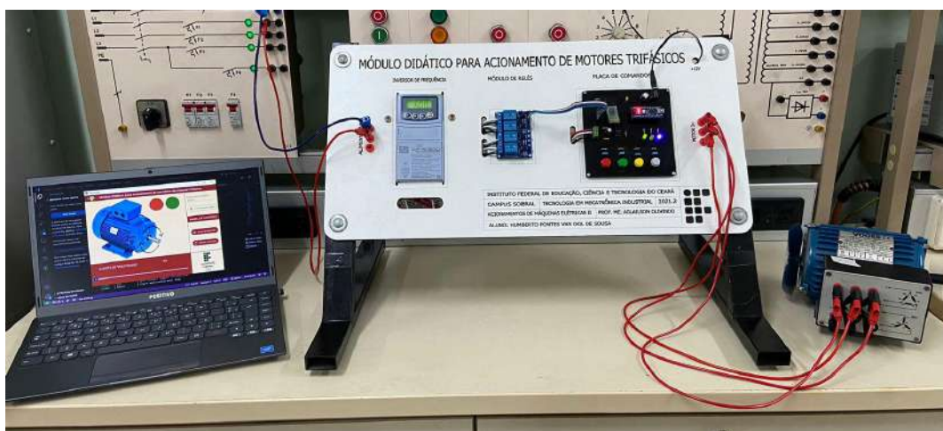
Figura 11 – Sistema com o módulo, supervisor e motor.
