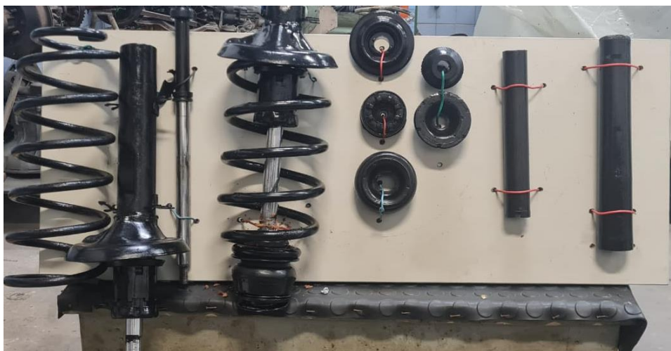
Fig. 1a – Sistema de suspensão de um veículo.
