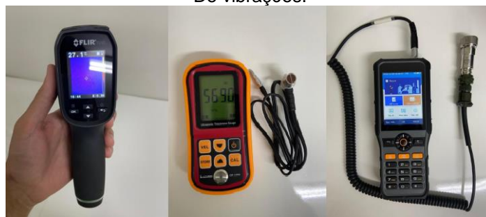
Figura 5 – Termovisor FLIR, aparelho de ultrassom e coletor De vibrações.
