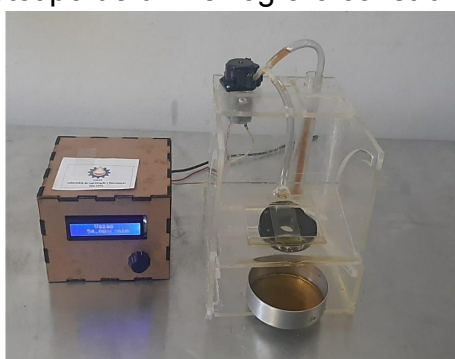
Figura 1 - Protótipo de um ferrografo construído no LUMAN
