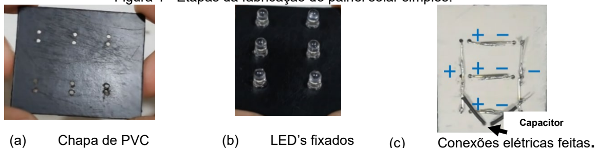
Figura 1 - Etapas da fabricação do painel solar simples.
