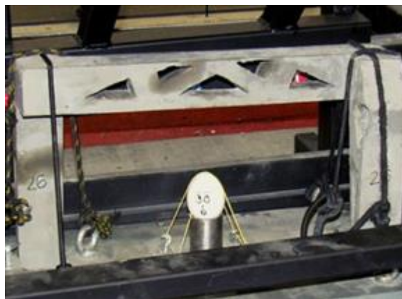
Figura 2. Viga de proteção com carga dinâmica a ser aplicada
