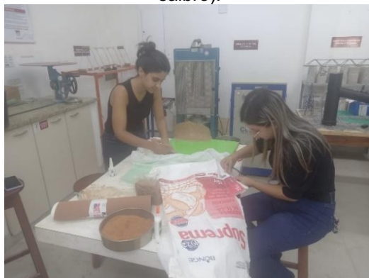
Figura 7 – Preparação da mistura (cimento e saibro).
