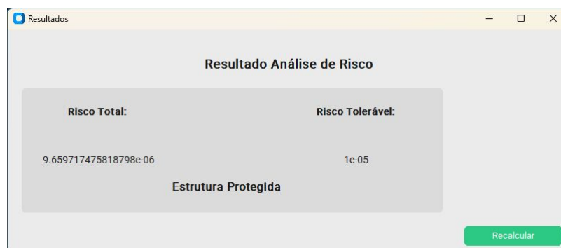
Figura 12 – Resultado da análise de risco para o HCB considerando as novas configurações do sistema.
