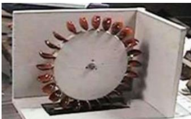
Figura 1 – Turbina modelo Pelton construída com materiais de baixo custo.
