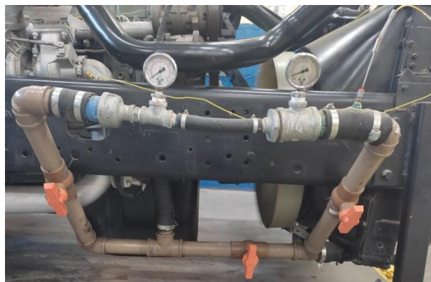
Figura 8 – Tubo de Venturi no Ciclo Diesel
