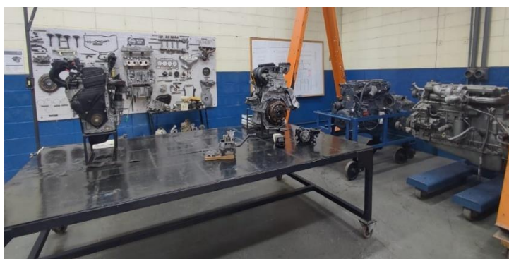
Figura 3- Motores de Ciclos Otto e Diesel utilizados para desmontagem e montagem.
