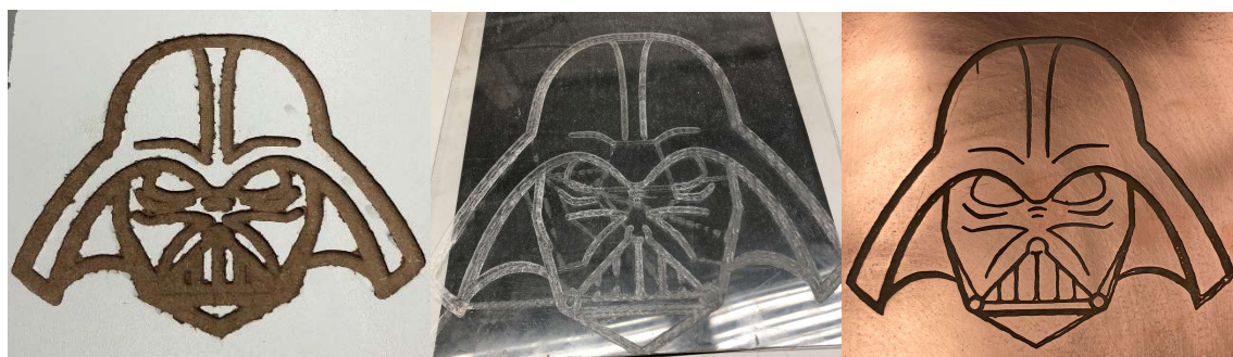
Figura 7 – Manufatura subtrativa em MDF, acrílico e placa de fenolite (da esquerda para direita).
