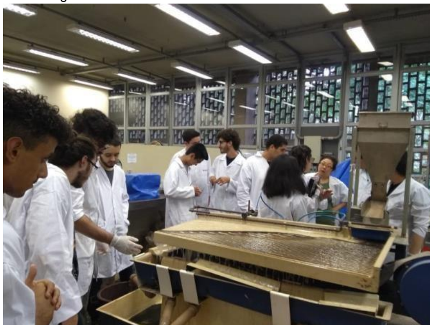
Figura 2 - Alunos realizando o ensaio de mesa vibratória
