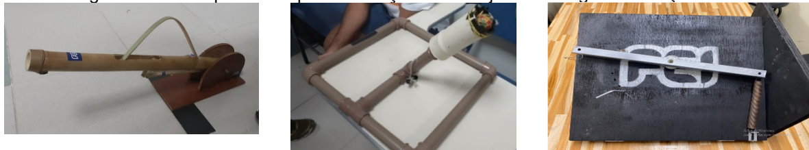
Figura 2 – Protótipos do dispositivo lançador com ajuste do ângulo de lançamento.
