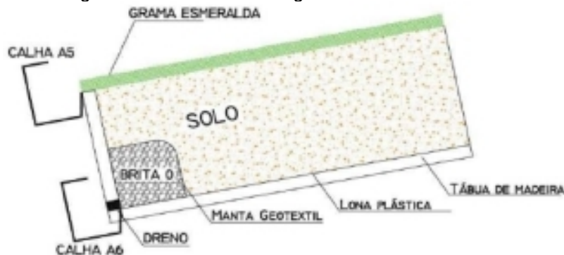
Figura 3- Detalhe da montagem de um telhado Verde
