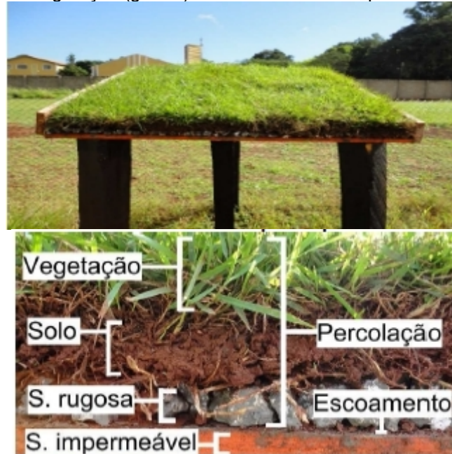
Figura 4 - Telhado com vegetação (grama) e uma mistura de isopor triturado com cimento (base)
