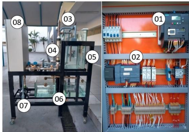
Figura 2 - Bancada didática de controle de nível utilizada nos experimentos e painel de comando, respectivamente.
