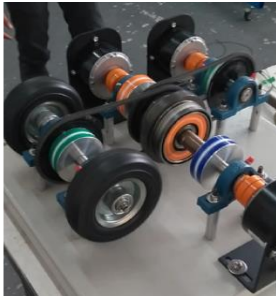
Figura 5 – Kit didático de Transmissão de Veículo Híbridos com motores CC.
