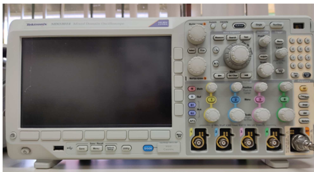
Figura 1 – Osciloscópio Tektronix MDO3014.
