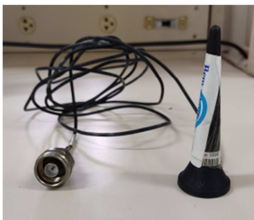
Figura 5 – Antena de 50 Ohms.
