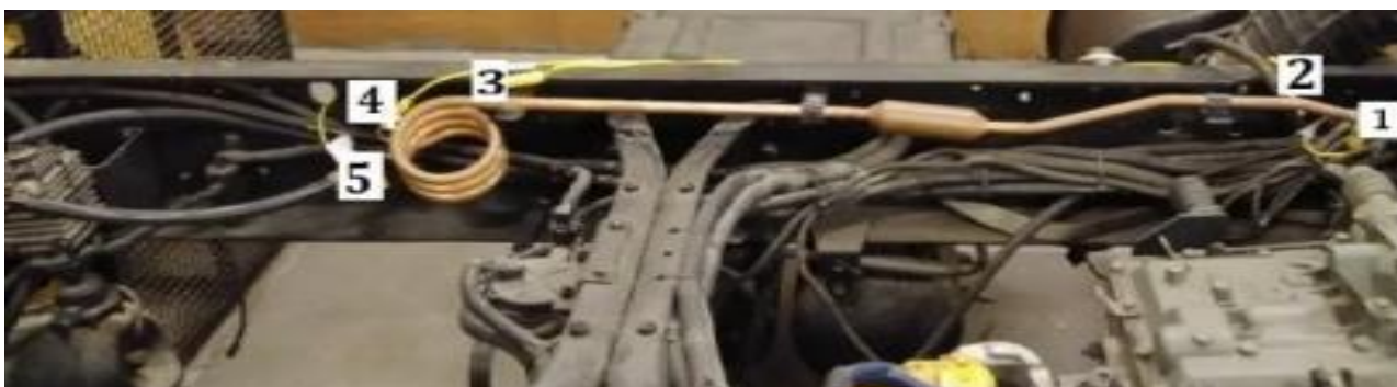
Figura 4 - Trocador de calor com os seguintes pontos de instrumentação: 1-Temperatura do fluido da parte externa; 2-Temperatura do Fluido Quente de Entrada ( T_{q,e} ); 3-Temperatura do Fluido Quente Antes do Coil; 4-Temperatura do Fluido Quente de Saída ( T_{q,s} ) e 5-Temperatura do Fluido parte externa.
