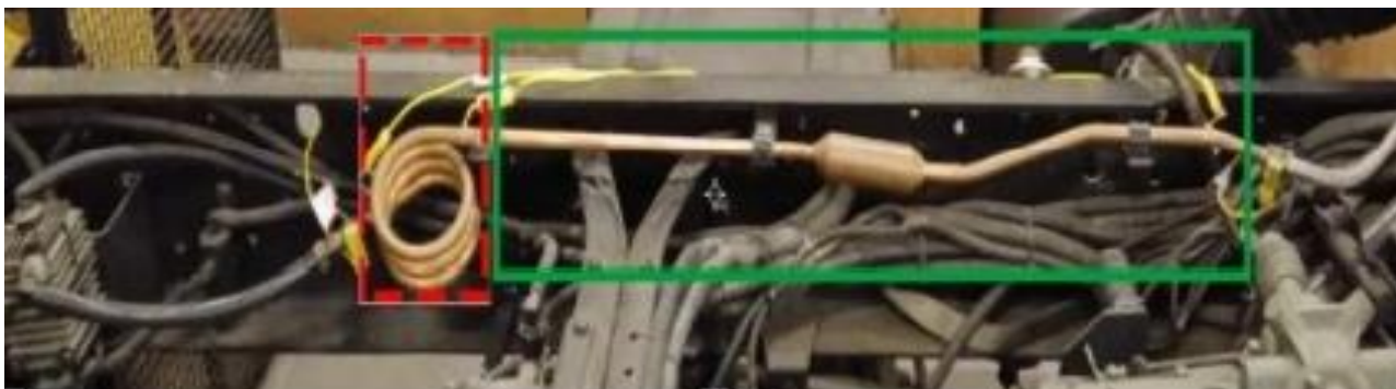
Figura 1 - Representação do trocador de calor em cobre com os volumes de controle linear (linha contínua) e volume de controle do "coil" (linha tracejada)
