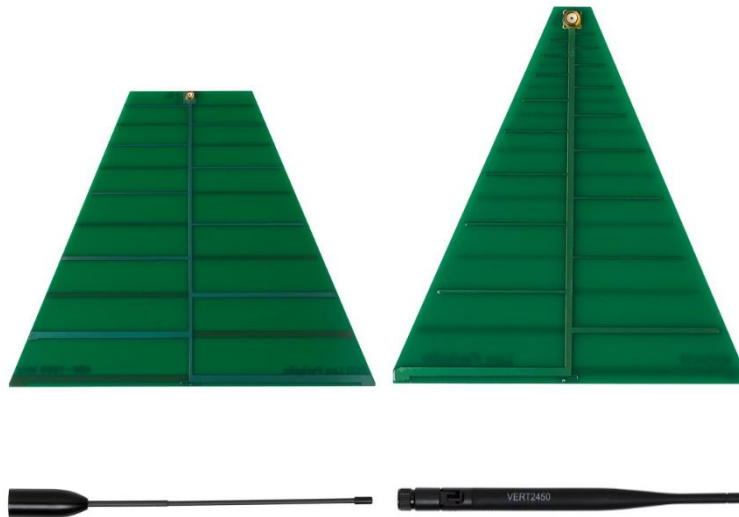
Figura 9 – Exemplos de antenas adquiridas no projeto veicular, duas direcionais e duas omni-direcionais.
