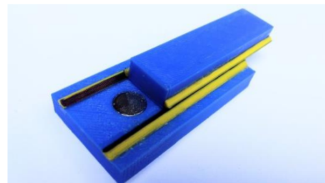
Figura 15 - Peça representativa de cisalhamento no metal-base e cisalhamento na garganta da solda.
