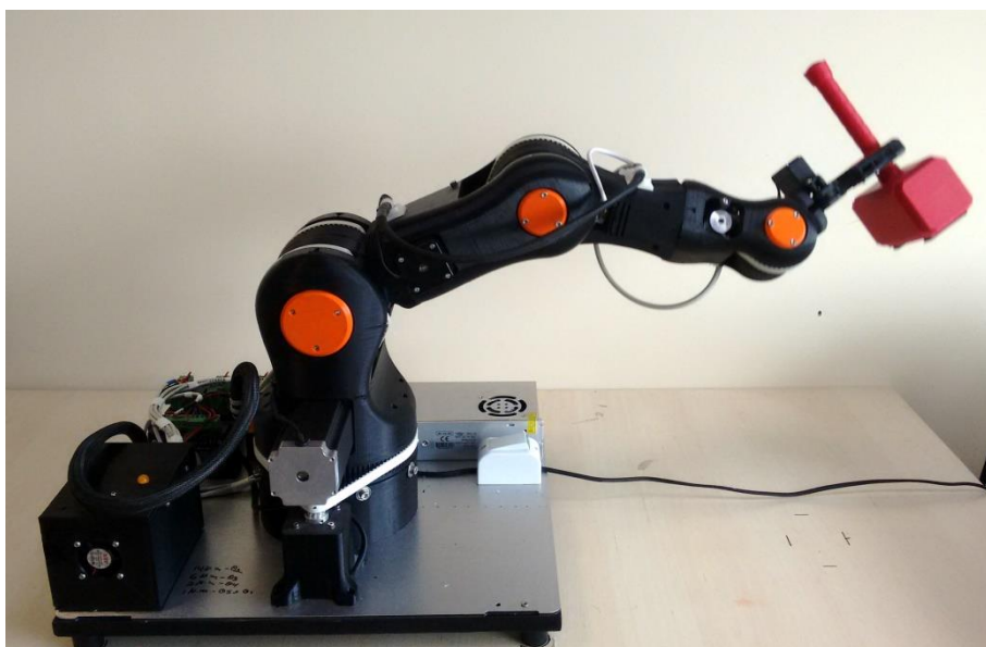
Figura 3 – Braço robótico em teste de velocidade de trabalho e repetibilidade.
