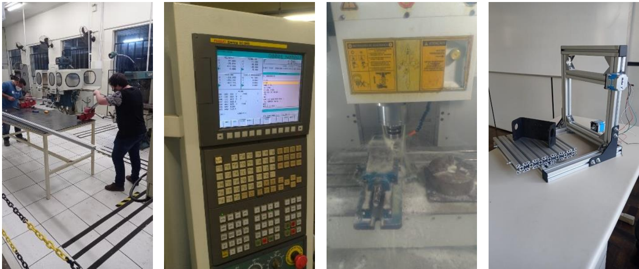
Figura 8 – Realização das atividades práticas na oficina mecânica: a) Corte de matéria-prima b) Programação em Centro de Usinagem c) Usinagem CNC d) Estrutura da Fresadora Router CNC.
