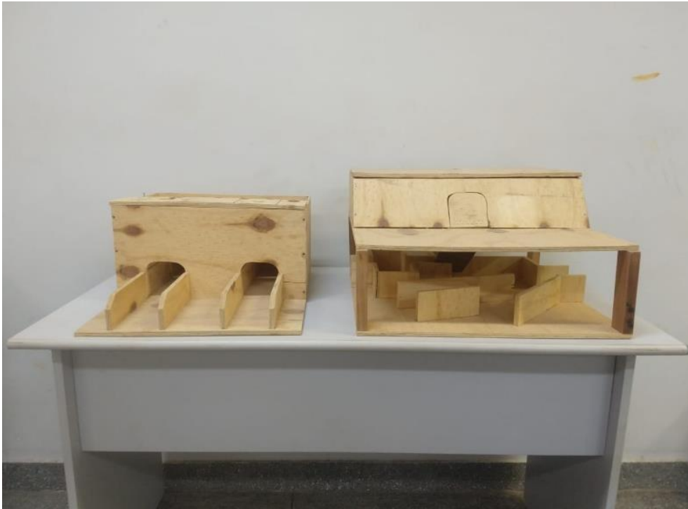
Figura 2: Maquete ilustrativa do método de lavra subterrânea Sub level Stopping - Vista frontal.
