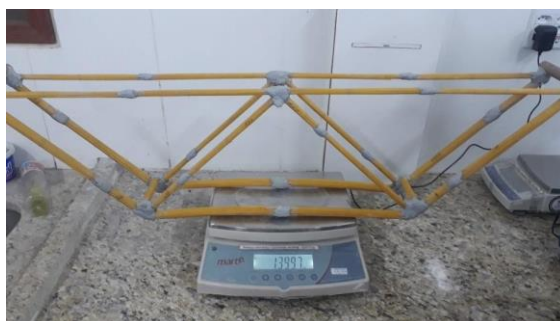
Figura 08 - Pesagem da ponte
