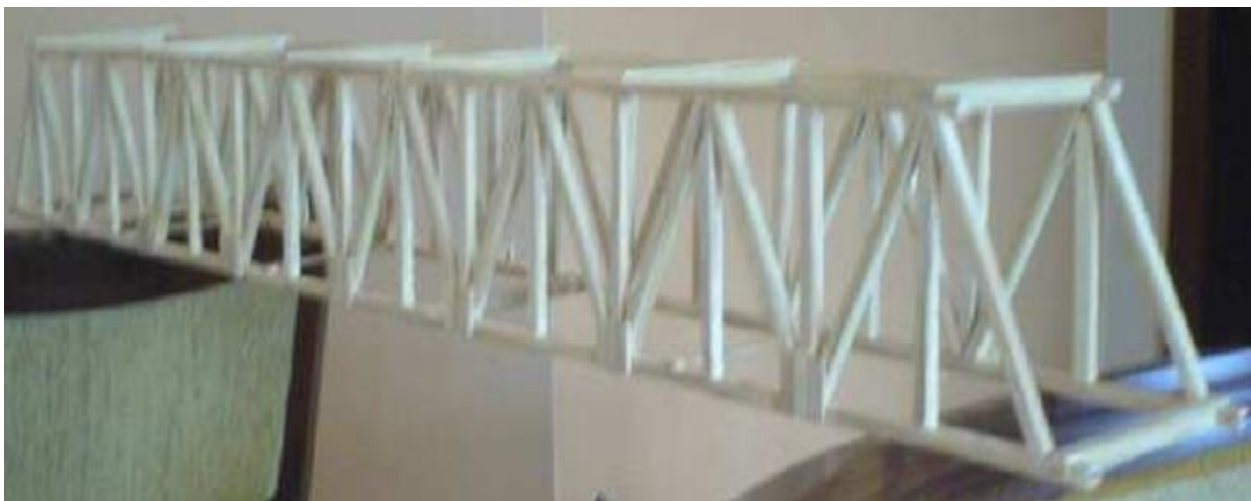
Figura 2: Modelo de ponte treliçada do tipo Warren Modificada construído com palitos de picolé.
