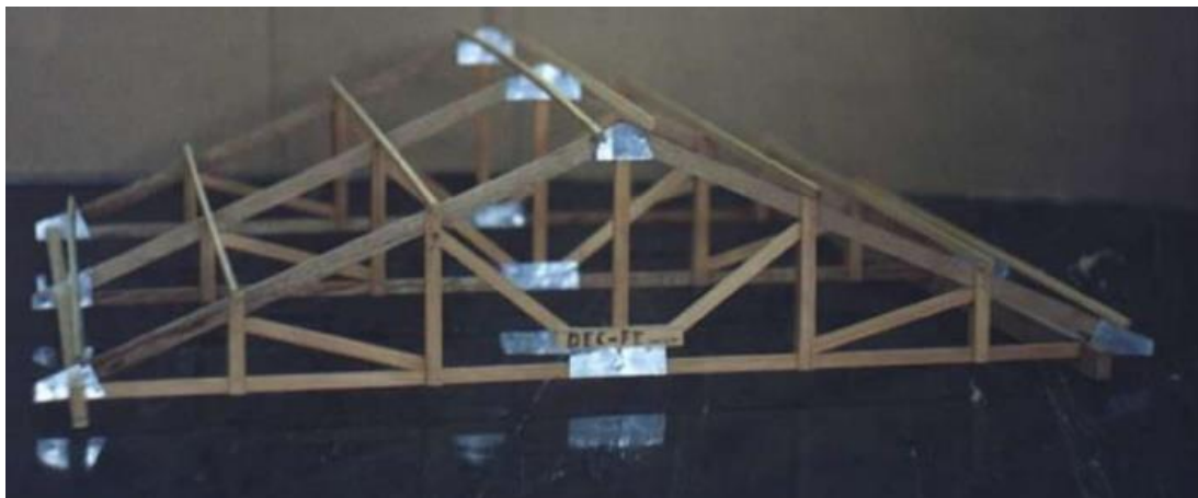
Figura 1: Modelos qualitativos de estruturas: (a) Sistema de cobertura em madeira com treliças howe
