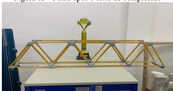
Figura 15 - Ponte após o teste de compressão
