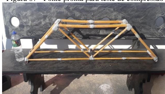
Figura 07 - Ponte pronta para teste de compressão
