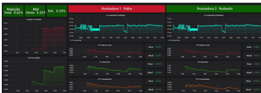
Figura 9 – Dashboard de supervisão de linha no Grafana para monitoramento da linha de produção
