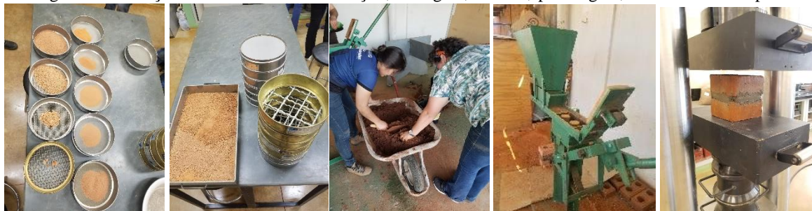
Figura 3: Produção e teste BSC: caracterização, dosagem, mistura, prensagem, resistência à compressão.
