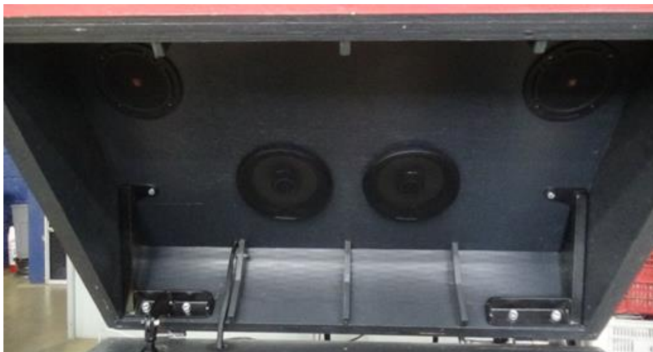
Figura 2.5 – Alto falante 6"/15Watts RMS de duas vias.
