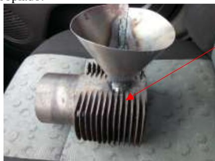
Camisa de cilindro fresada e com o funil já unido por soldagem, para realizar a função do canal de descida (funil) e da matriz metálica (cilindro do motor).
