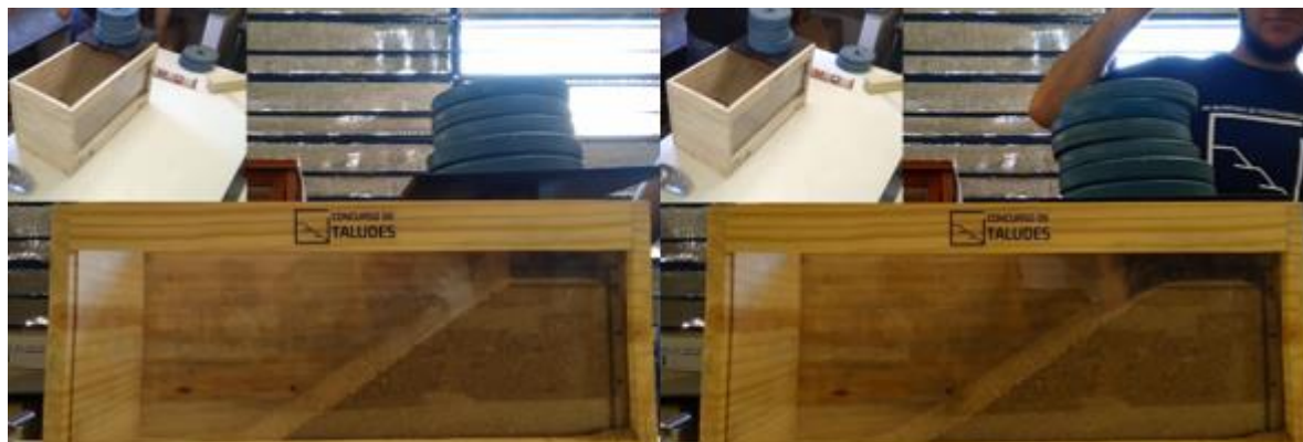
Figura 2 – Aplicação da carga, à esquerda, e momento de ruptura, à direita.
