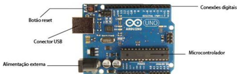
Figura 2 – Vista superior da placa Arduino Uno.
