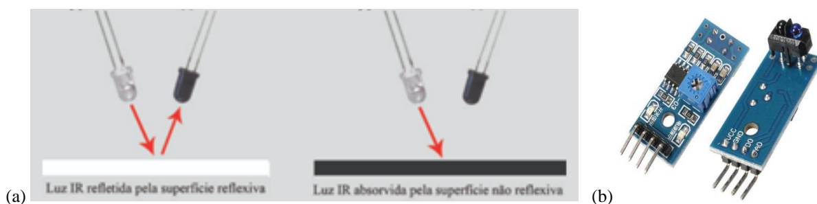
Figura 4 - (a) Característica de reflexão de infravermelho, (b) Módulo eletrônico sensor de linha.
