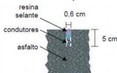
Figura 4 – Detalhe de laços indutivos na via
