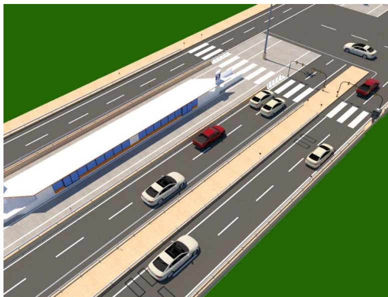
Figura 9 - Ilustração da via principal fechada com a via de retorno aberta – vista superior
