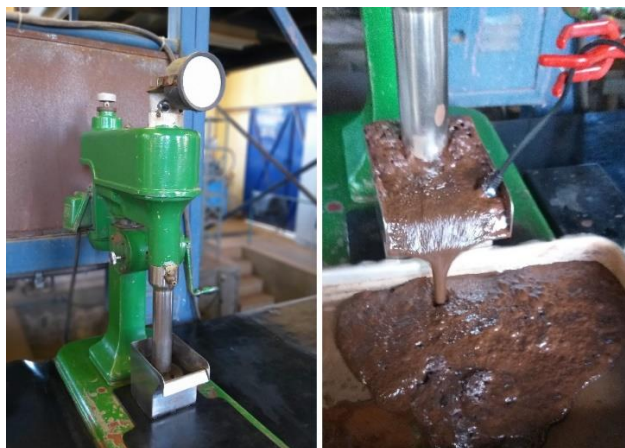
Figura 4 – À esquerda, a célula de flotação; à direita, detalhes da coleta da espuma mineralizada e o posicionamento da sonda condutivimétrica.
