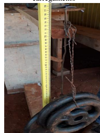
Figura 5 - Viga de madeira de 50 cm com 18 kg de carregamento
