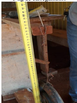
Figura 4 - Viga de madeira de 50 cm com 3 kg de carregamento
