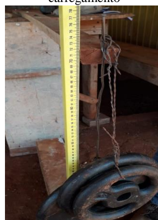
Figura 5 - Viga de madeira de 50 cm com 18 kg de carregamento
