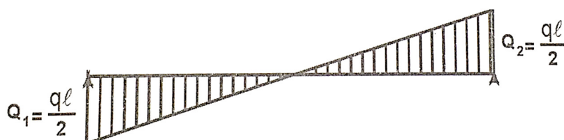
Figura 1 – Exemplo de diagrama de esforço cortante.
