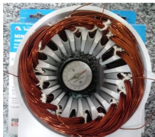
Figura 4 - (a) Esquemático do enrolamento de campo do MIT, (b) Estator com enrolamento de campo.
