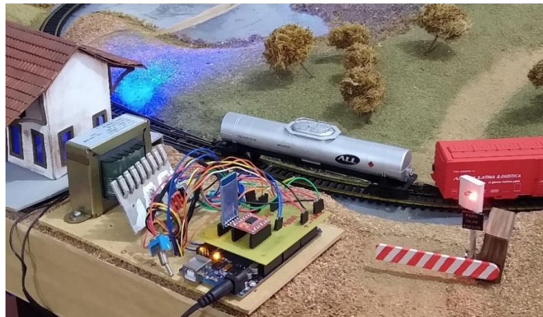
Figura 5 – Foto da maquete contendo os equipamentos do sistema elétrico.
