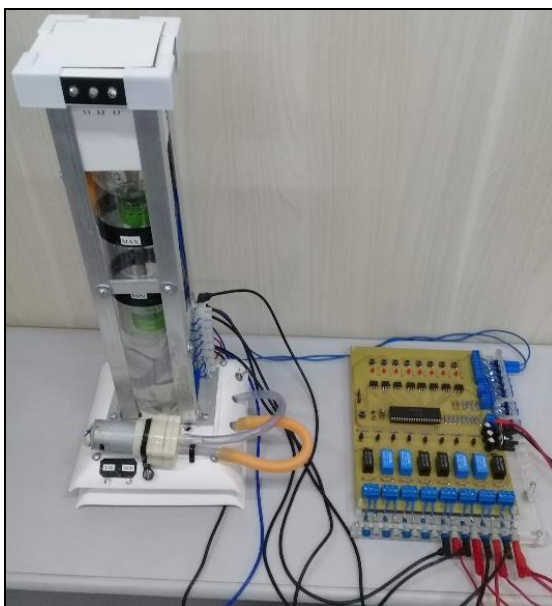
Figura 6 – Protótipo do reservatório de líquido em atuação, conectado ao CLP
