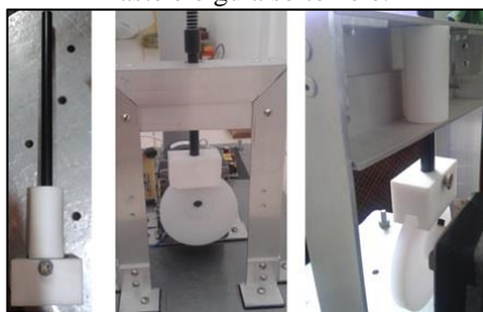
Figura 2- Came-seguidor com a parte face plana acoplado na haste e o guia solto nele.
