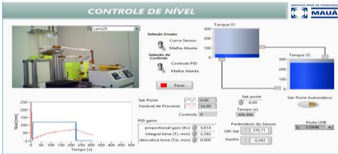
Figura 2 – Interface do WebLab de Controle de Nível em um Tanque.
