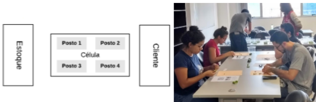
Figura 3 - Layout da fábrica e composição das mesas durante as simulações no modelo enxuto
