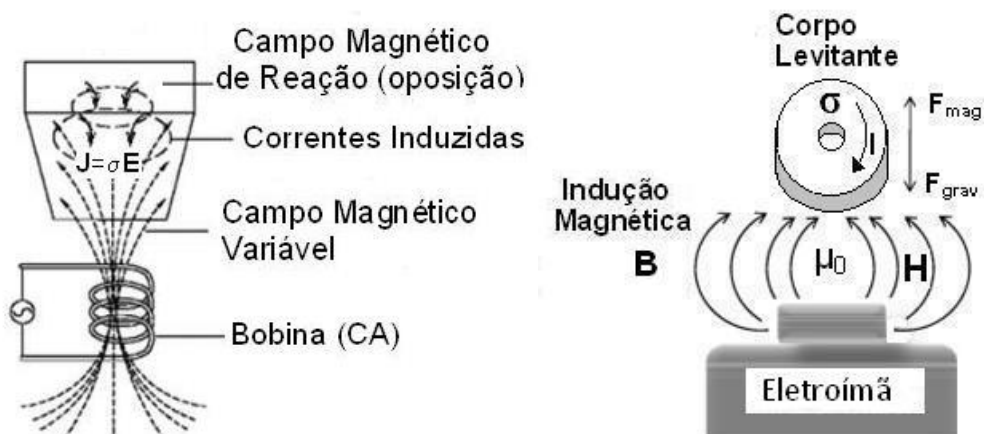
Figura 2 – Correntes Induzidas – Força de Repulsão.
